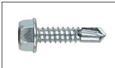
Imagen 9: Tornillos autotaladrantes DIN 7504 A2 6,3x25
