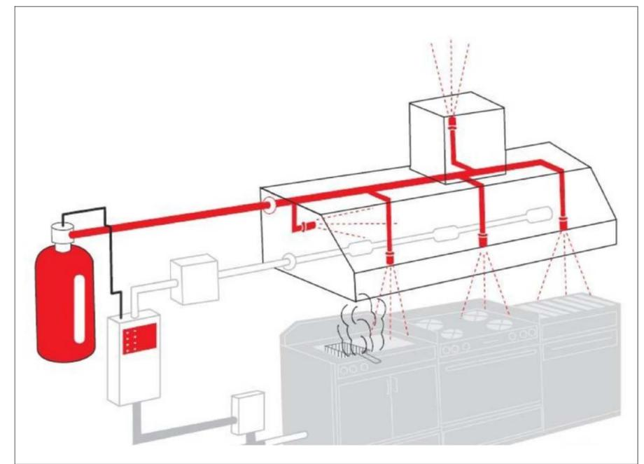
DETALLE TIPO SISTEMA AUTOMÁTICO DE EXTINCIÓN DE INCENDIOS EN CAMPANA EXTRACTORA
