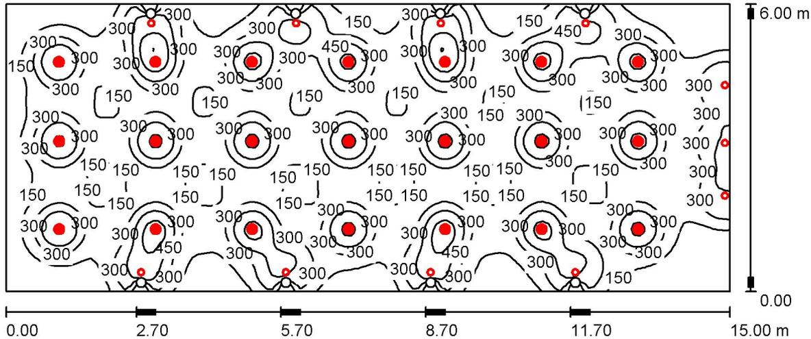
Altura del local: 3.000 m, Altura de montaje: 3.000 m, Factor mantenimiento: 0.80
