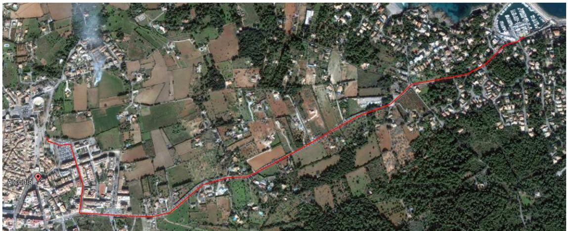
Figura 4.-Trazado de eventual conducción de impulsión para conexión con sistemas generales (en el núcleo de Alcudia)
