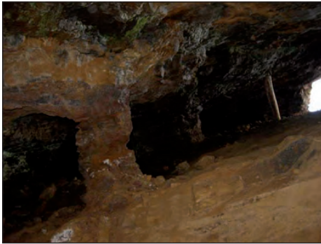
Sistema d'exploració, forats i pilars.
